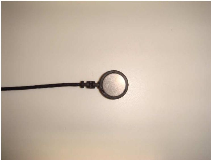
Abb 2.6 Oberflächenelektrode zur Temperaturmessung
