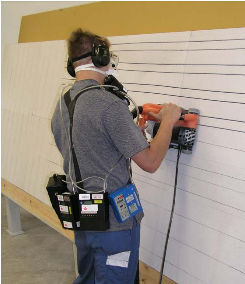
**Bild 1:** Einsatz einer Mauernutfräse am Prüfstand
