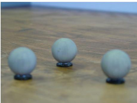
Abb. 3.8: Passive, Licht reflektierende Marker.
