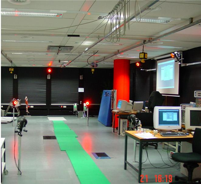
Abbildung 3.7: Ganglabor mit VICON 624-Bewegungsanalyse-System mit 12 Infrarot-Stroboskop-Kameras
