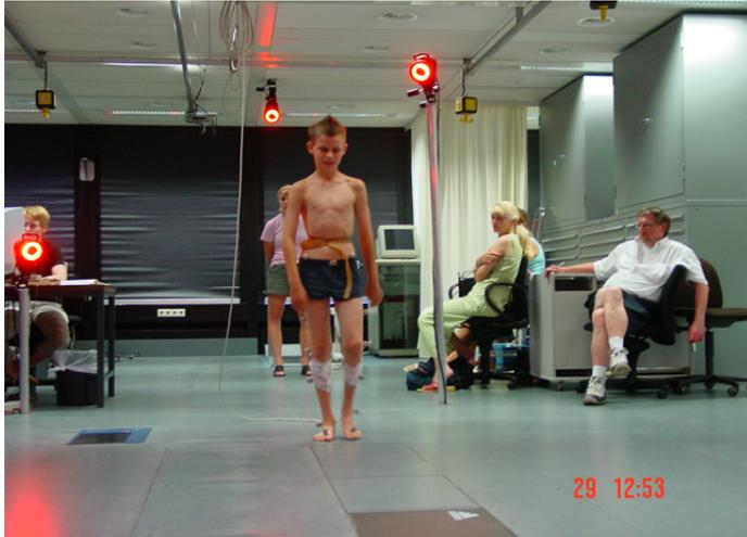
Abbildung 3.11: Durchführung einer Messung mit angelegten Markern
