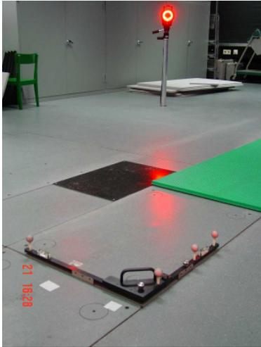
Abbildung 3.10: Dynacal Calibration L-Frame
