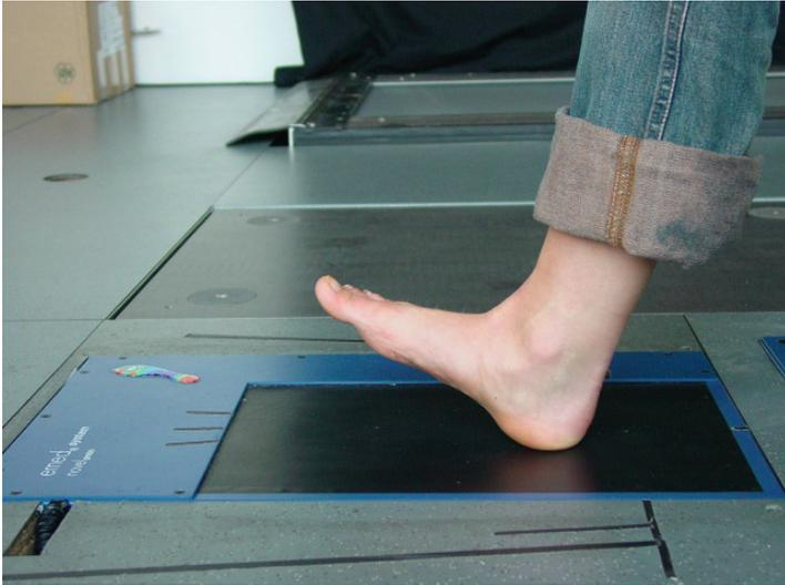
Abbildung 3.2: Messplatte
