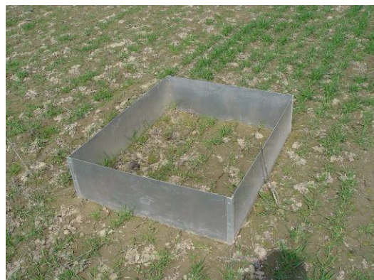
Abb. 25: Aluminium-Rahmen (Flächeninhalt: 1 m 2 ) für den Enclosure-Exclusion-Test
