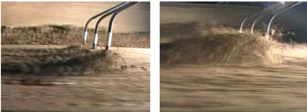
Abbildung 3: Flughöhe von Bodenpartikeln beim Striegeln mit 3 cm Arbeitstiefe bei den Geschwindigkeiten 4 und 8 km/h.
