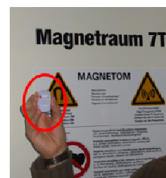
Abbildung 4: MALSE Prototyp und dessen Aktivierung im Zugangsbereich zum Magnetraum eines 7,0 T Ganzkörper-MR-Tomographen.
