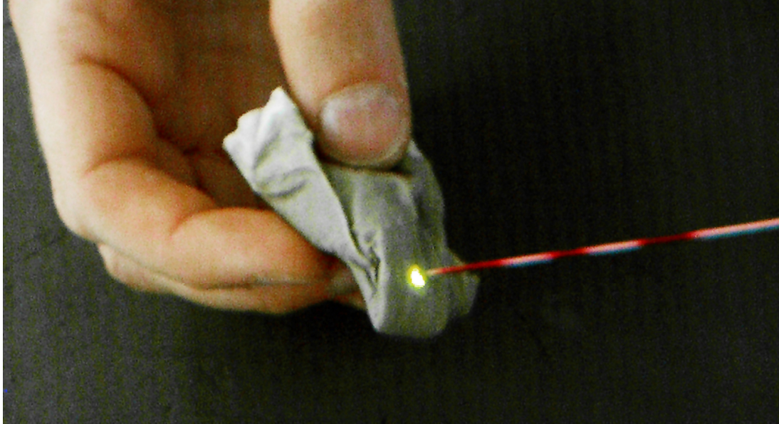
Abb. 3: Freiliegendes Ende eines CFK-Drahtes mit Lichtbogenbildung
