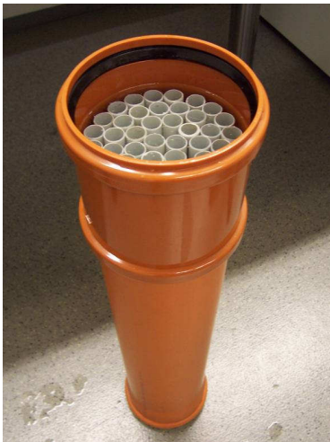
Abbildung 3: Strukturphantom bestehend aus 43 Röhren mit 13mm Durchmesser.
