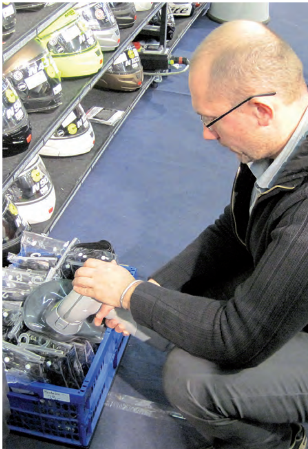
Abbildung 2: Untersuchung mittels RFA-Messgerät vor Ort
