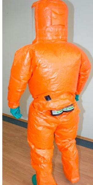
Abb. 38 Atemschutzanzug, Gebläse innerhalb (GM)
