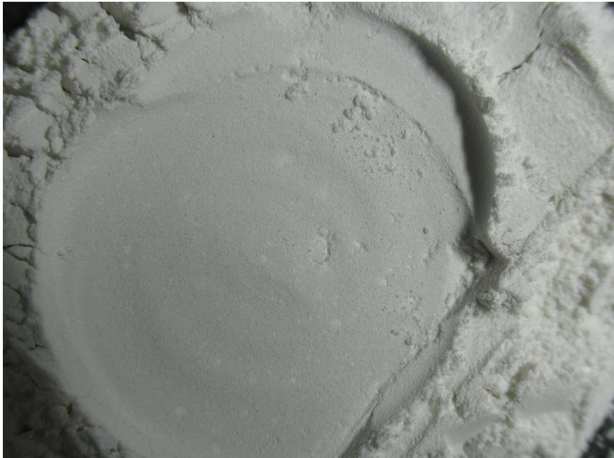
**Abbildung 28** Darstellung des inhomogenen Pulvergemenges von Z102 und  $\text{BaSO}_4$
