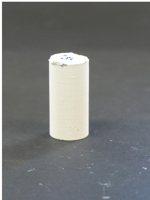
**Abbildung 26** Manuell angemischter Probekörper, bestehend aus Z102, ZB 56 und  $\text{BaSO}_4$
