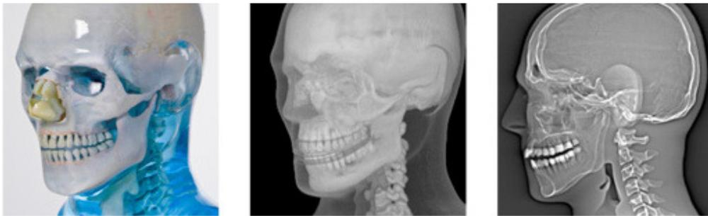
**Abbildung 18** ATOM®max Dental & Diagnostic Head Phantom(links), DVT-Aufnahme (mitte) und sagittale Ansicht (rechts)
