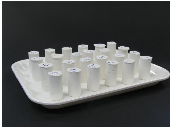
**Abbildung 27** Serie manuell hergestellter Probekörper
