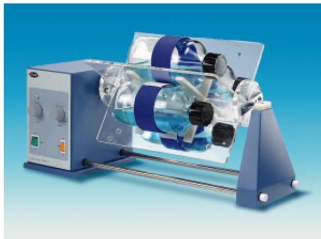
**Abbildung 29** Darstellung eines Überkopfmischers
