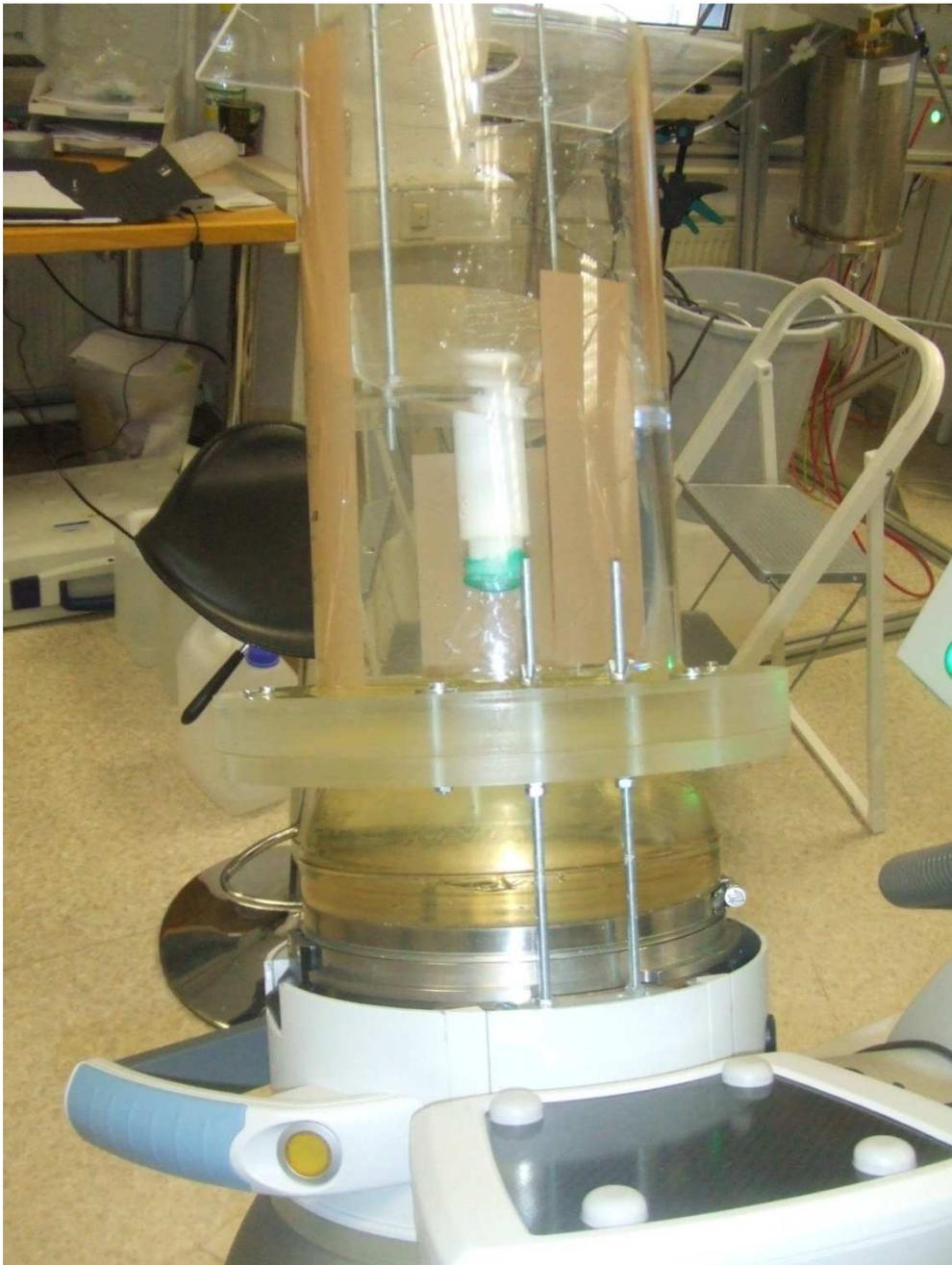
**Abbildung 15: Modifizierter Performancetopf / Testtopf auf dem Stoßwellenkopf**
