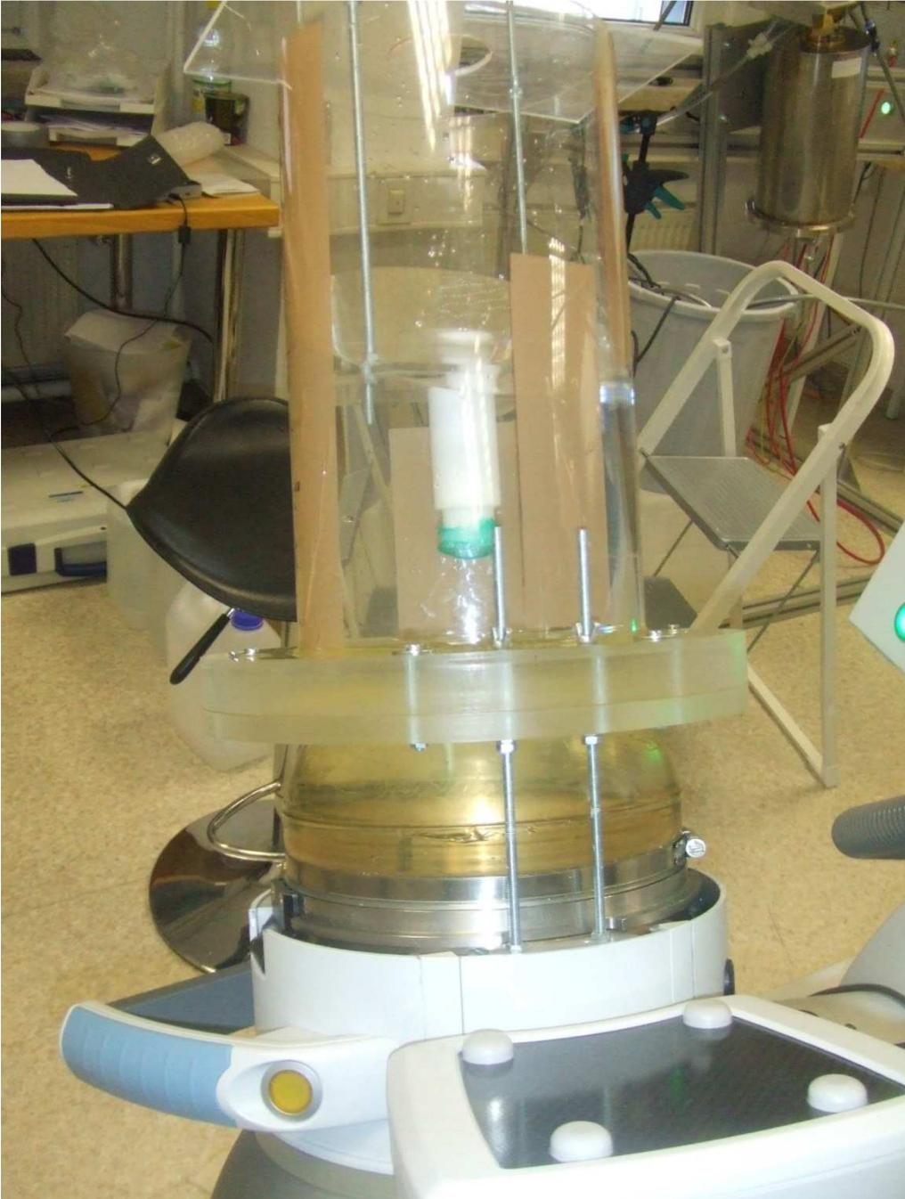
**Abbildung 18: Testaufbau: Steinhalter mit grünem Steinnetz im wassergefüllten mod. Performancetopf / Testtopf**
