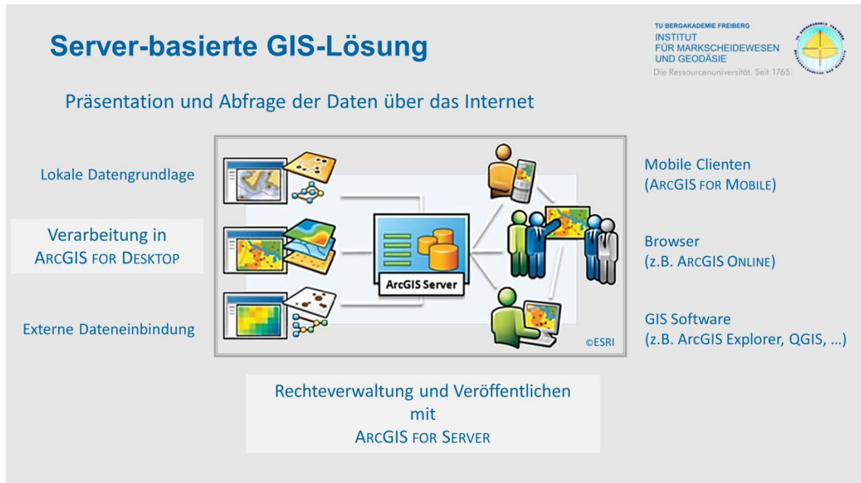
Abbildung 3: Schematische Darstellung der serverbasierten GIS-Lösung (TU Bergakademie Freiberg 2013)
