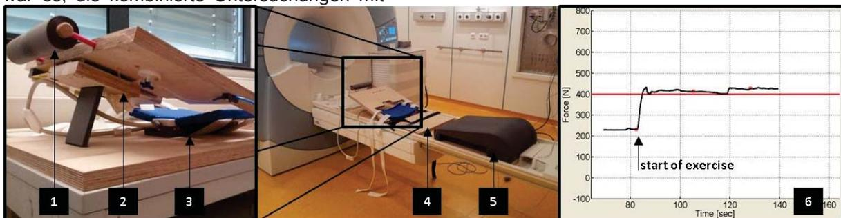
**Abb. 1:** MR-kompatibles Ergometer zur isometrischen Rückenstreckübung bestehend aus einer Rückenablage (1), einen Kraftsensor (2) zwischen dieser Ablage und der an den MR-Tisch adaptierten Grundplatte (4). Die Hüfte wird mit Gurten fixiert, die Beine auf ein Kissen gelagert (5) und die Kraftkontrolle erfolgt durch ein interaktives Feedback (6).
