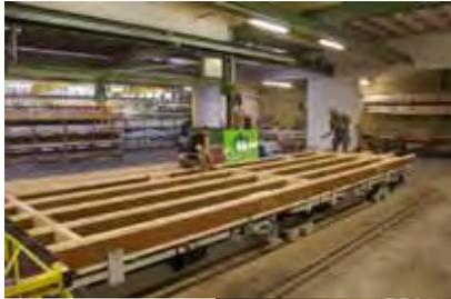
lückenloses Einbringen flexibler Holzfaser-Dämmung, minimale Wärmebrücken durch Stegträger
