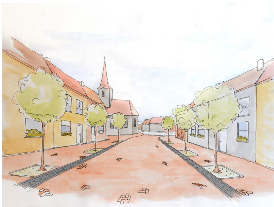
Abbildung 13: Weiche Separation des Straßenseitenraums von der Fahrbahn mittels Muldenrinnen
