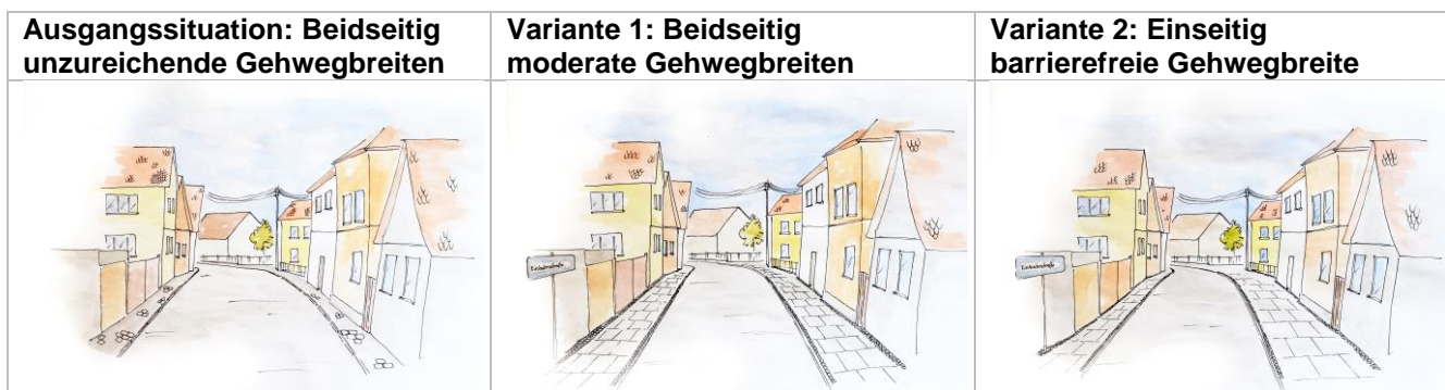
Abbildung 3: Änderung von Straßenquerschnitt und Verkehrsführung zugunsten breiterer Gehwege
