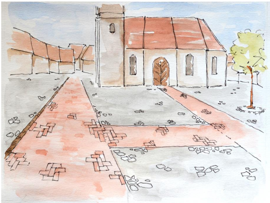
Abbildung 12: Korridore mit gut berollbarem Oberflächenbelag im Bestandspflaster
