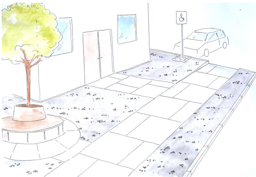
Abbildung 2: Stufenloser, gut berollbarer sowie taktil und visuell wahrnehmbarer Oberflächenbelag
