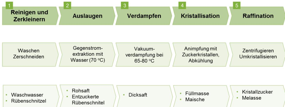
Abb. 5: Verfahrensschema zur Herstellung von Zucker aus Zuckerrüben<sup>5</sup>
