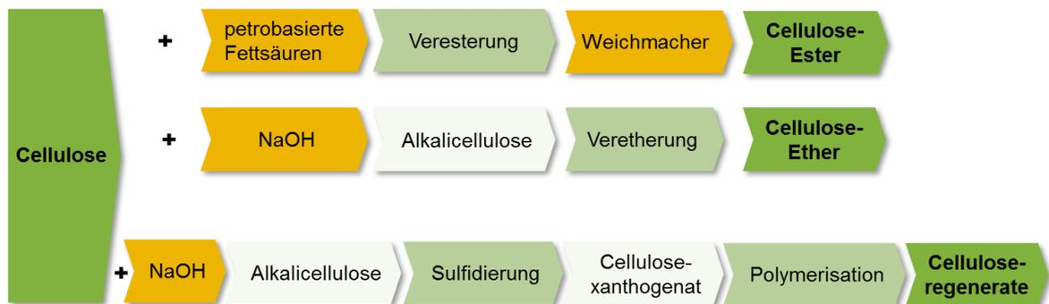
Abb. 113: Cellulose basierte Polymerwerkstoffe
