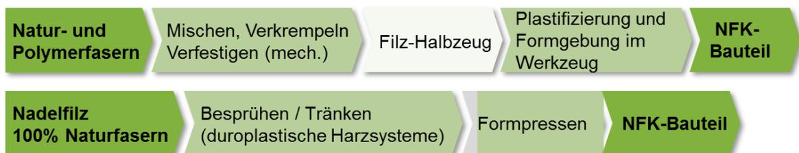
Abb. 114: Prozessschritte der NFK Formpressung
