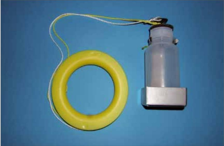
Abb. 5: Beispiel für ein Wasserprobenahmegerät
