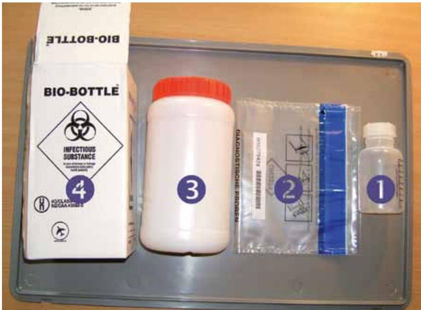
Abb. 2: Beispiel für eine Verpackung nach P620: 1 Primärgefäß (Probengefäß), 2 versiegelbarer PE-Beutel (wasserdicht) wird an der Dekontaminationsstelle getaucht, 3 Sekundärgefäß, verbleibt im grünen Bereich dient als sichere Transportverpackung ins Labor (für P620 BAM geprüft), 4 äußere Verpackung, Kartonverpackung deklariert für B-Proben der Kategorie A.
