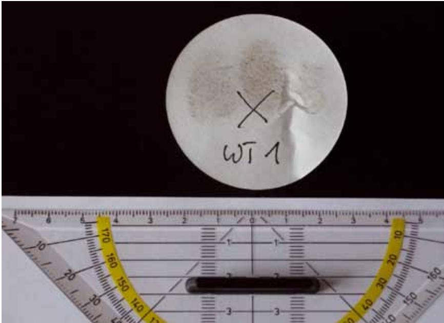
Abb. 11: Wischprobenahme mit beschriftetem Filter und Größenvergleich
