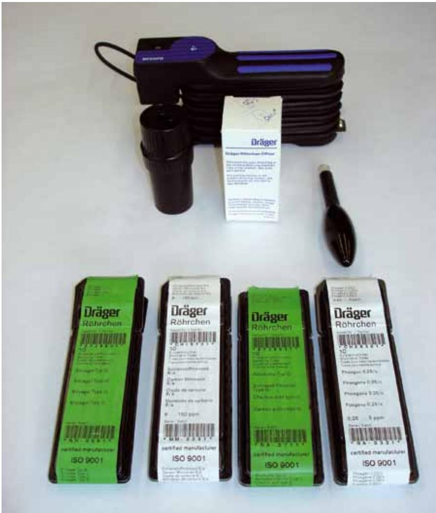
Abb. 6: Beispiel für Sammelröhrchen mit Röhrchenöffner und manueller Pumpe
