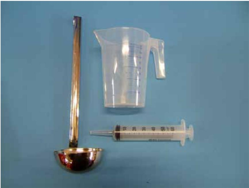
Abb. 10: Geeignete Probenahmematerialien zur Entnahme von Flüssigproben: Kelle, Messbecher, Spritze
