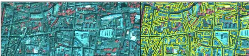
Abb. 5.12 Ergebnis der Segmentierung von Einzelgebäuden, auf Ikonos überlagert
