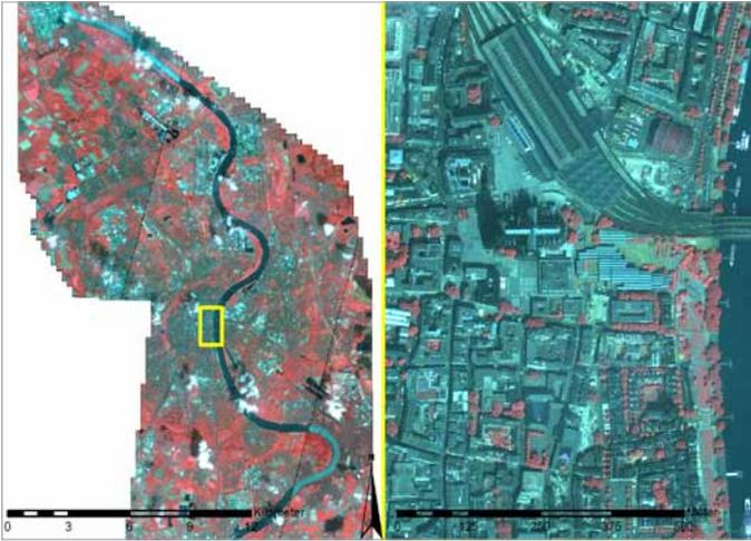
Abb. 5.2 Abdeckung des Untersuchungsgebietes Köln mit höchstauflösten optischen Satellitenbilddaten (Ikonos-Falschfarbinfrarotdarstellung, Bandkombination 4/3/2)
