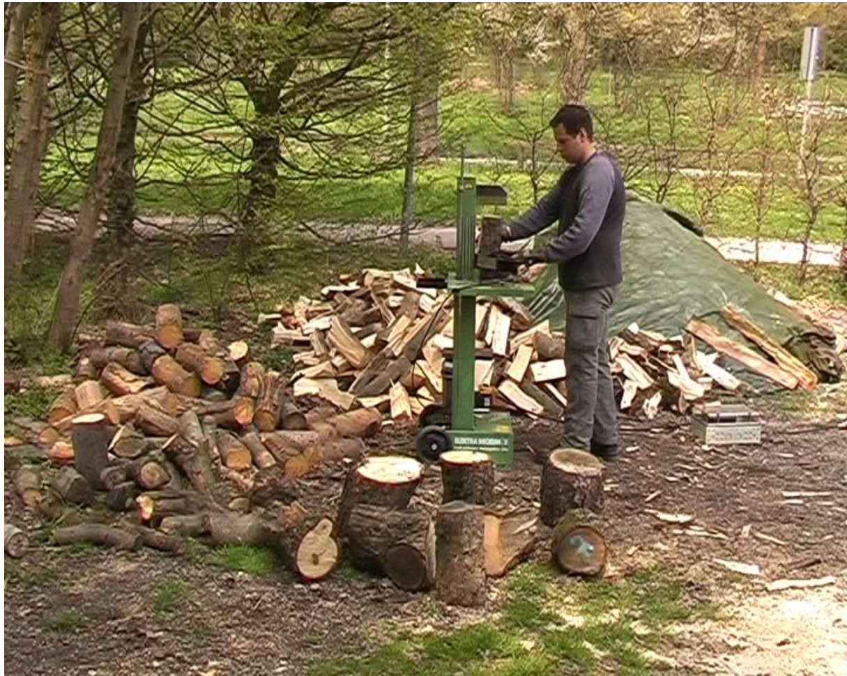
Abbildung 53: sk1.jpgArbeitsplatzbeispiel für Zeitstudie zum Spalten mit kleinem Senkrechtpalter
