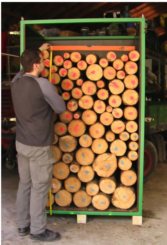
Abbildung 16: messung_volumen.jpg Der Messrahmen für die Bestimmung der Scheitholz Raummaße
