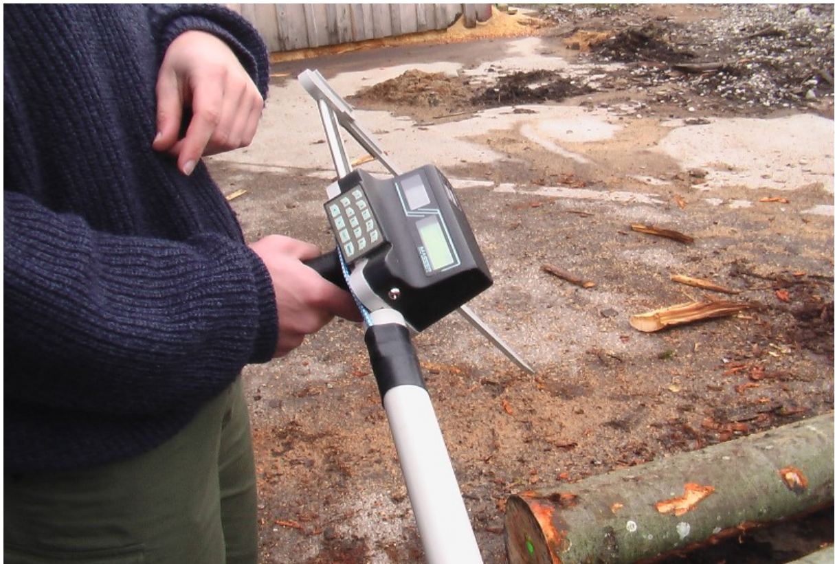
Abbildung 9: ekluppe.jpg Elektronische Kluppe für die Durchmesserbestimmung
