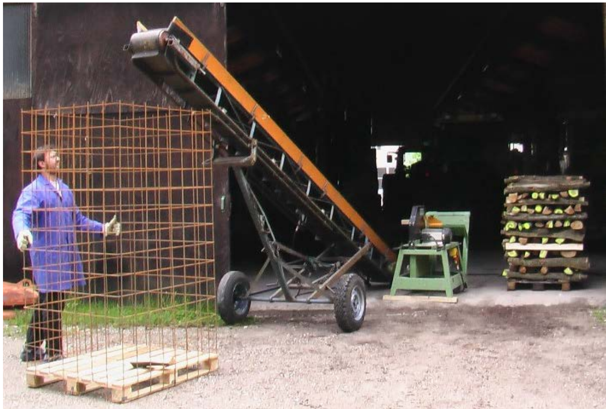
Abbildung 19: konradgitterb.jpg Befüllen der Gitterbox für die Schüttvolumenbestimmung
