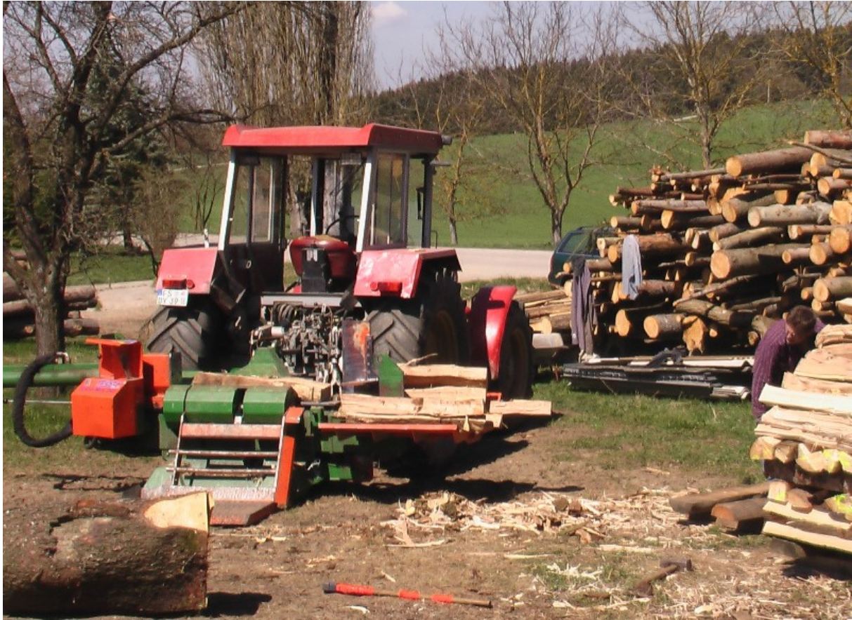
Abbildung 62: waagrechtdecker2.jpg Arbeitsplatzbeispiel für Zeitstudie zum Spalten mit großem Waagrechtspalter (hier: Hydromax 24 t, Fa. Posch)
