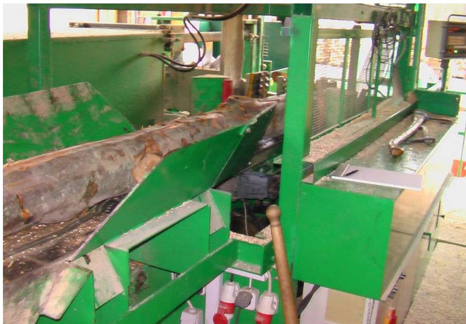
Abbildung 71: kretzer2.jpg Arbeitsplatzbeispiel für Zeitstudie zum Spalten mit der großen kombinierten Säge-Spaltmaschine (GK). Hier: Herkules II, Fa. Kretzer
