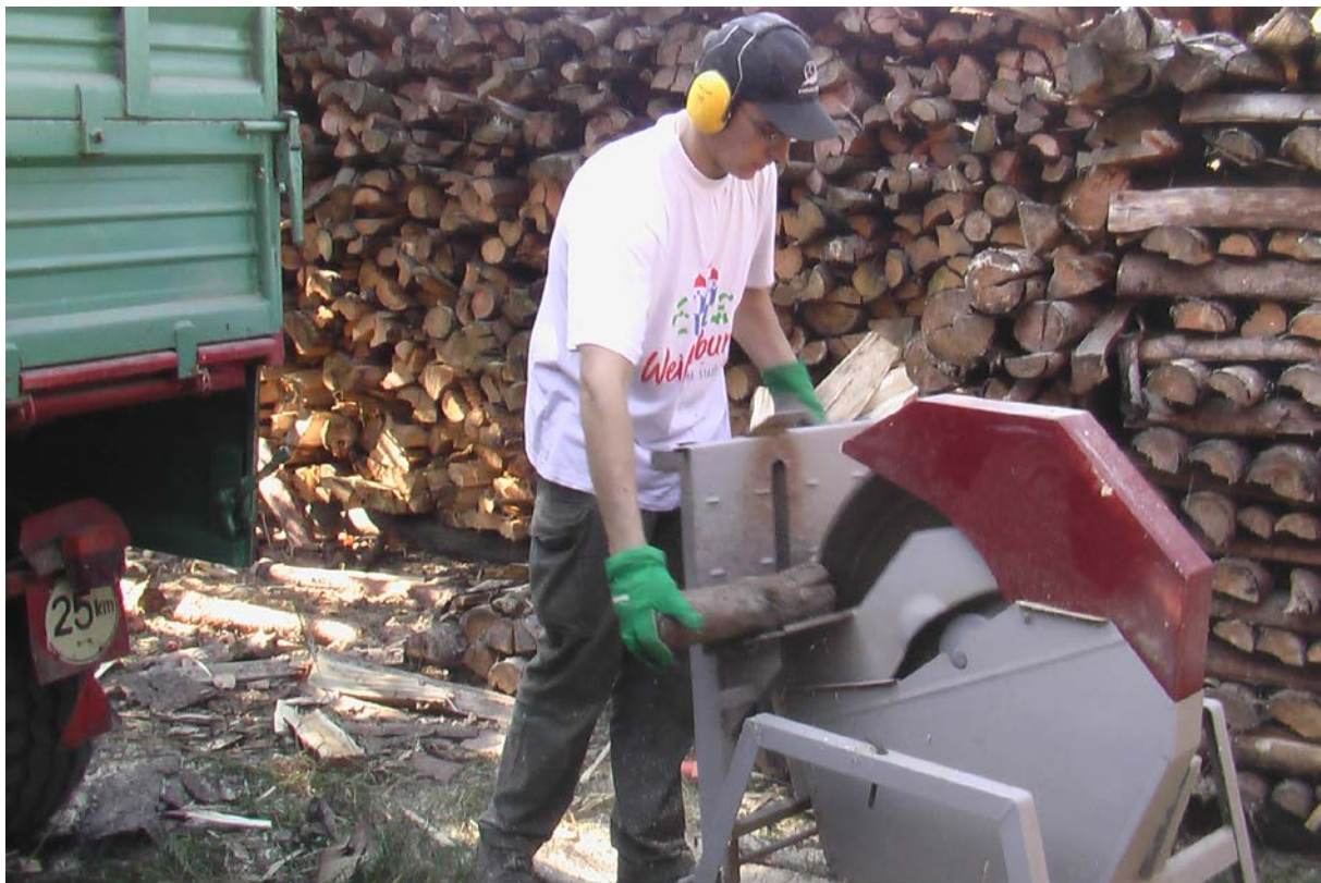
Abbildung 75: haslauer_säge.jpg Arbeitsplatzbeispiel für Zeitstudie zum Trennschnitt mit der Kreissäge (KR). Hier: WK 771, Fa. BGU
