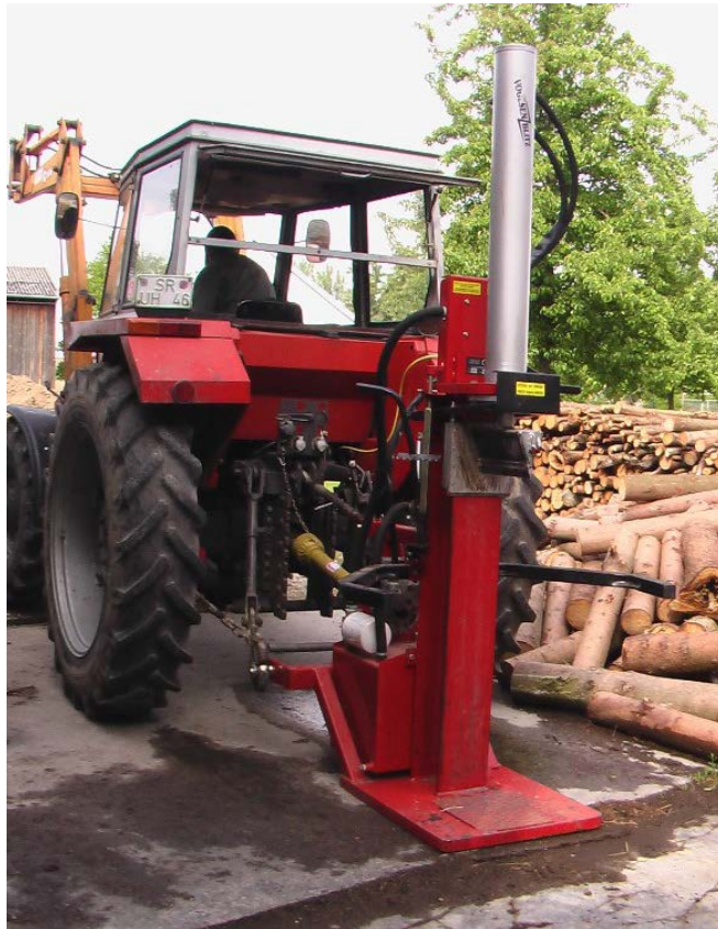
Abbildung 57: senkrechtblitz.jpg Arbeitsplatzbeispiel für Zeitstudie zum Spalten mit großem Senkrechtpalter (hier: Spaltbrummi, Fa. Vogesenblitz)
