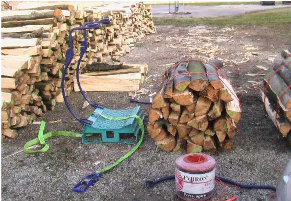
Abbildung 77: wp34.jpgArbeitsplatzbeispiel für das Stapeln und Bündeln mit einer Bündelhilfe, hier für 0,5 Rm-Bündel
