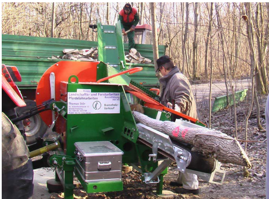
Abbildung 67: kleinkombwald.jpg Arbeitsplatzbeispiel für Zeitstudie zum Spalten mit der kleinen kombinierten Säge-Spaltmaschine (KK). Hier: Spaltfix 300, Fa. Posch)
