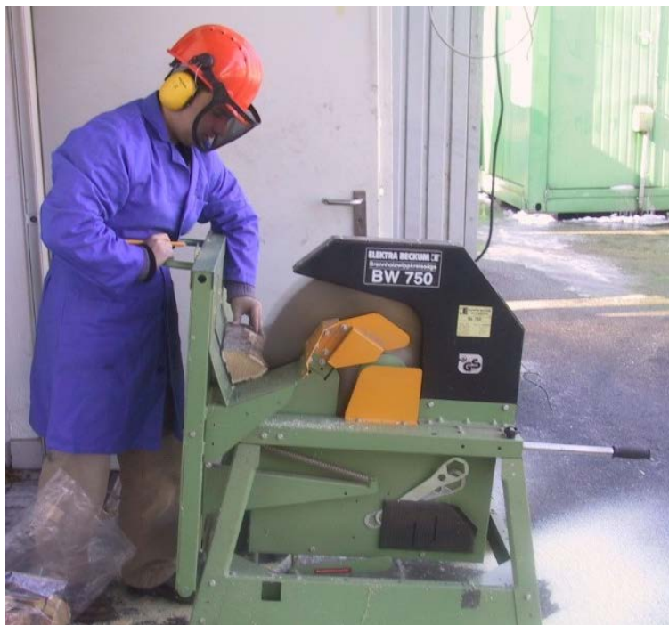
Abbildung 24: lagerversuch/alexprobe.jpg Probenahme mit Kreissäge für Wassergehaltsbestimmung
