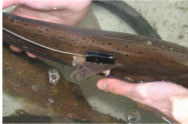
Abb. 69: Meerforelle mit Telemetriesender
