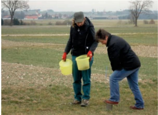
Die Probenahme-Teilflächen müssen zuvor mit GPS oder anderen Systemen möglichst genau eingemessen werden, um sicherzustellen, dass auch nach mehreren Jahren die gleiche Stelle beprobt wird. Von dieser Teilfläche wird eine Mischprobe aus mehreren Einstichen (z.B. mit dem  $N_{\min}$ -Bohrer) bis 15 cm Tiefe gezogen.
