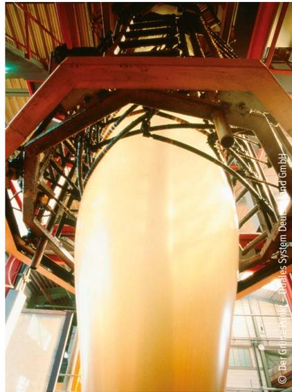
Bild 5.3: Blasfolien-Extrusion
