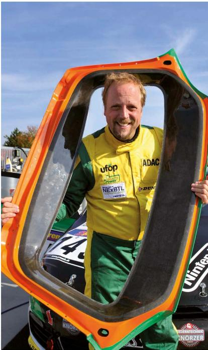
Bild 6.11: Heckklappe aus naturfaserverstärktem Kunststoff
