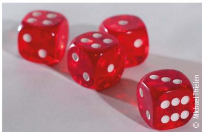
Bild 4.5: Transparente Würfel aus Celluloseacetat
