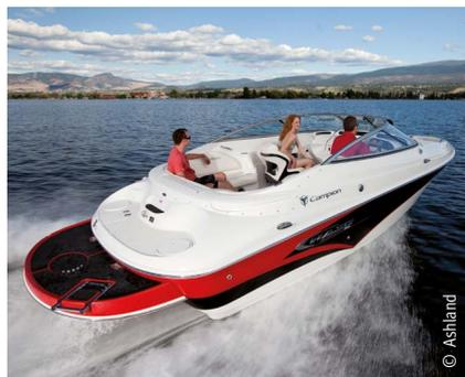
Bild 4.14: Rennboot aus teil-biobasiertem UP-Harz
