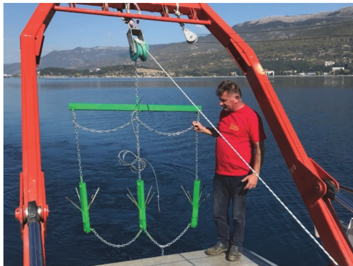
Abb. 1: Modellversuche zur Bergung von Geisternetzen am Ohridsee
