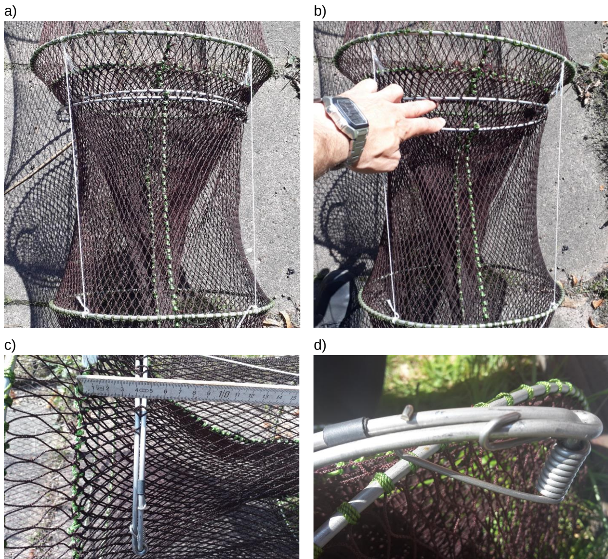
Abb. 3: Federbügel: a) Ausgangsposition, b) Bügel geöffnet, c) Abstand zur Kehle, d) Federkonstruktion.
