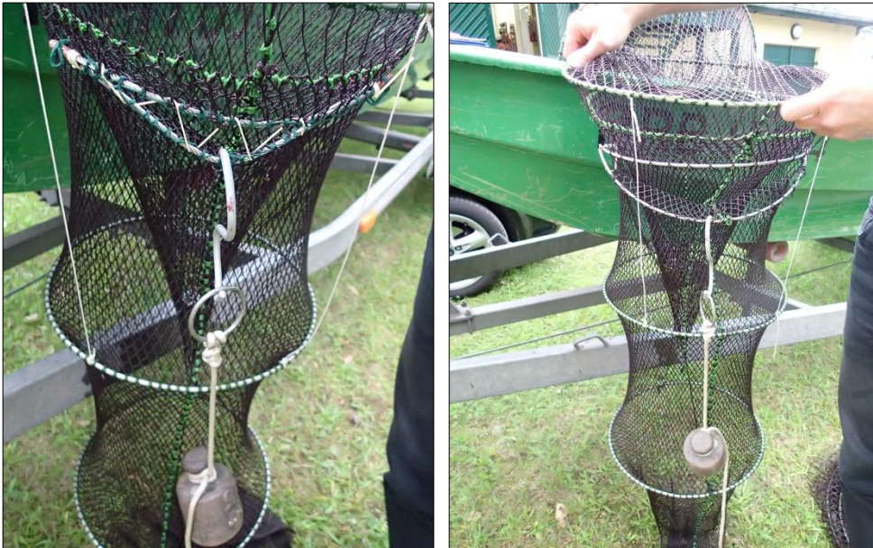
Abb. 4: Ermittlung der Öffnungskraft bei den getesteten Otterausstiegen.
