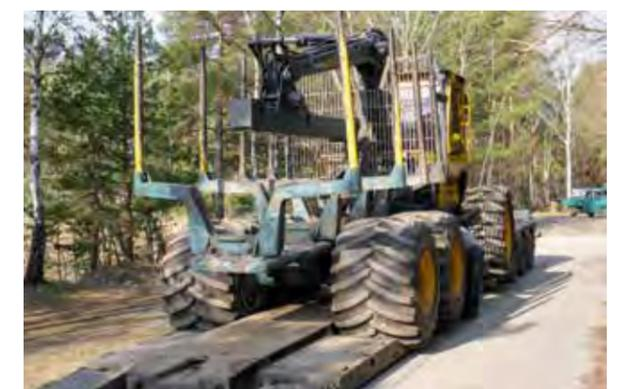
Abb. 1: Forwarder HSM 208 F 6WD mit Bogiebändern (Terra-X TXL 150, links) und Superbreitreifen (rechts)
