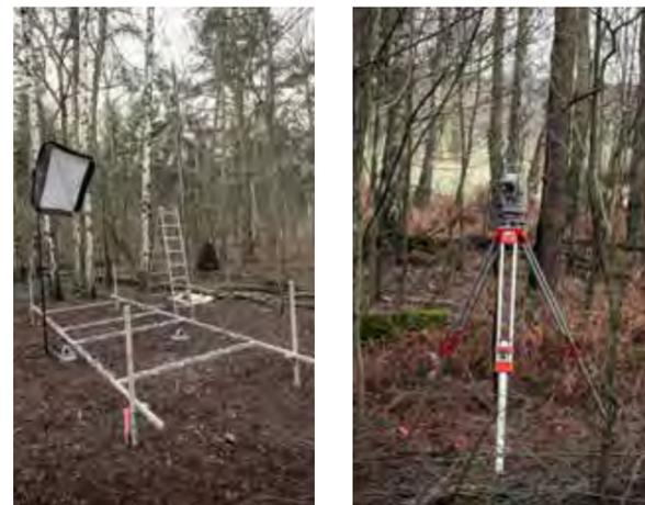
Abb. 2: Aluminium-Messrahmen für die photogrammetrische Datenaufnahme (links) und elektronische Totalstation SOKKIA Set5 zur Lagebestimmung sowie Nivellierung des Messrahmens (rechts)
