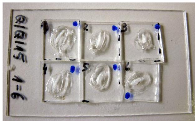
Abb. 3: Objektträger mit sechs Querschnitten von Quappenotolithen (Probennummern Q-Q-15-1 bis Q-Q-15-6) für die Elementanalyse. Die blauen Punkte markieren die längere Seite des jeweiligen Otolithen.
