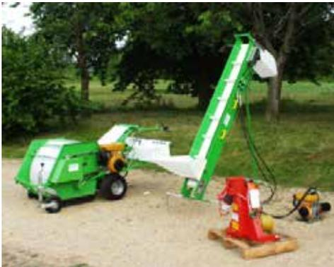
Handgeführte Sammelmaschine mit Lade-förderband und Seilschüttler (rechts)
