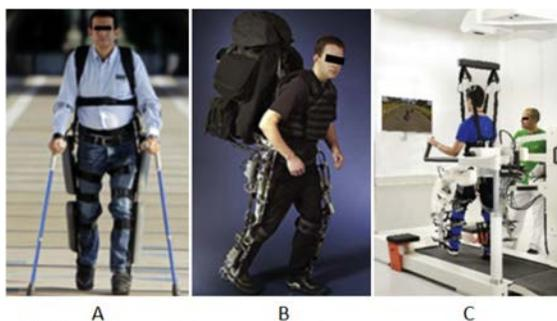
Abbildung 1: Exoskelett-Anwendungen; (A) Alltag, (B) Militär, (C) Rehabilitation. [7]
