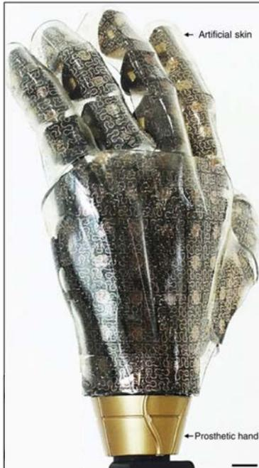
Abbildung 1: Handprothese mit elektronischer Haut [1]
