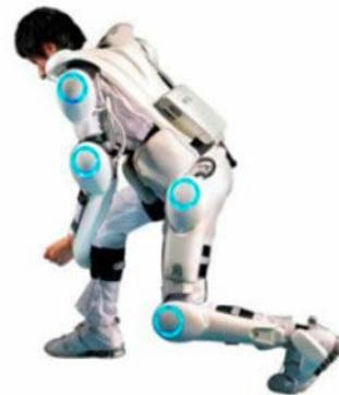
Abbildung 3: Angetriebenes Exoskelett – HAL-5-Roboteranzug für obere und untere Extremitäten. [2]
