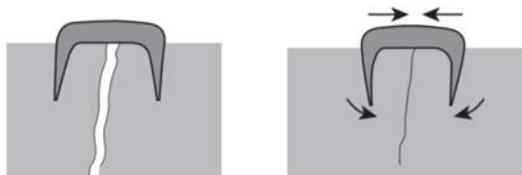
*Abbildung 4: Schematische Darstellung der Funktionsweise von NiTi-Klammern. Links: NiTi-Klammer in gespreizter Form. Rechts: Die sich schließende Klammer übt Kompression auf die Knochenfragmente aus (siehe Pfeile), wodurch deren Heilung unterstützt wird. [16]*
