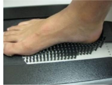
Abbildung 1: Digitalisierung eines Fußsohlenprofils mit einem Stift-Kontakt-Digitalisierer [5]
