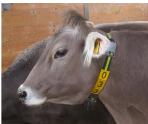
Abb. 2: Halsband-Sensor Heatime® Pro zur Messung von Aktivität und Wiederkäuen
