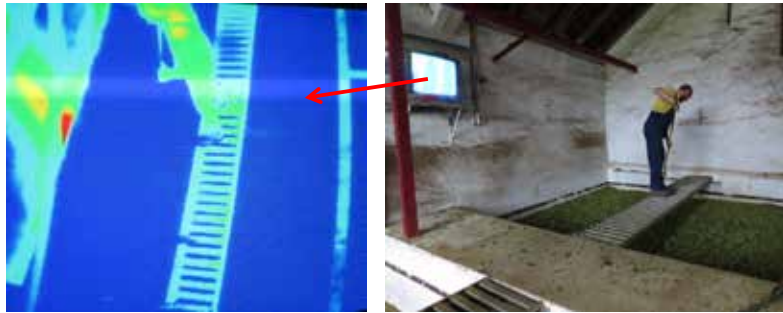
Abb. 54: Kontrolle auf gleichmäßige Schüttdichte nach dem Befüllen der Aufschütthorde und auf Gleichmäßigkeit während der Trocknung (Bilder: Selmeier G., 2016)
