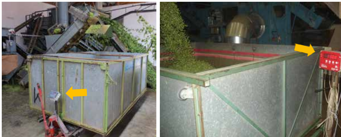
Abb. 46: Praxisbeispiele für Wiegevorrichtungen zur Ermittlung des Schüttgewichts von Grünhopfen
