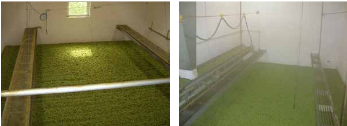
Abb. 30: Verlust ätherischer Öle über wasserdampfgesättigter Abluft (rechtes Bild)
