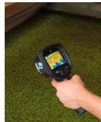
Kontrolle auf Gleichmäßigkeit der Trocknung in der Aufschütthorde mit Wärmebildtechnik
