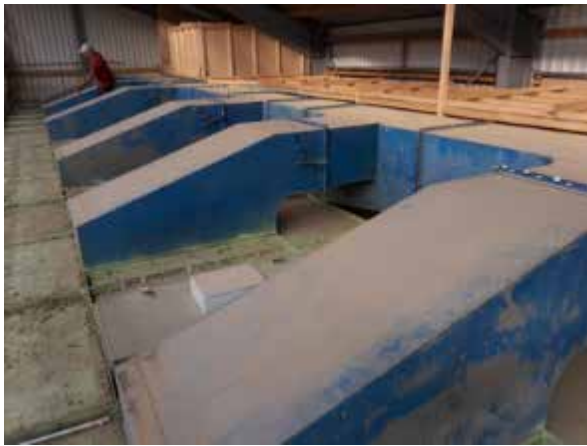
Abb. 71: Abluftsystem beim Dreibandtrockner tschechischer Bauart
