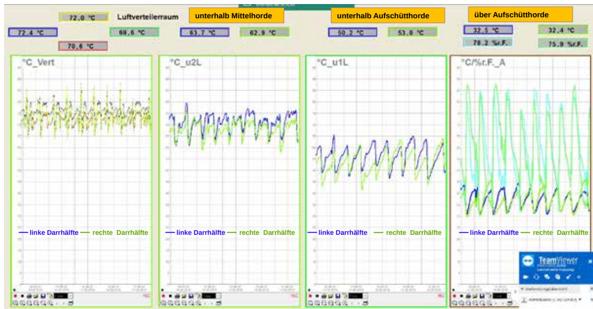
Abb. 56: Praxisbeispiel für die Dokumentation des Temperaturverlaufes der Trocknungsluft beim Einströmen in die einzelnen Trocknungslagen
