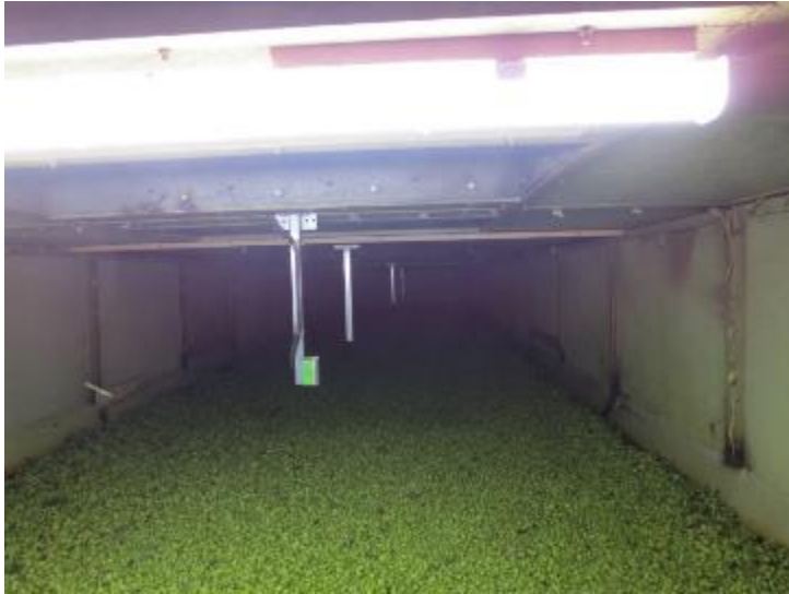
Abb. 68: Messung der Temperaturen und relativen Luftfeuchten über dem oberen Trocknungsband des Bandtrockners zur automatischen Schütthöhenregelung
