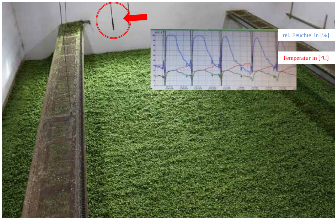
Abb. 51: Messen der relativen Feuchte und der Temperatur der Darrabluft über der Aufschütthorde
