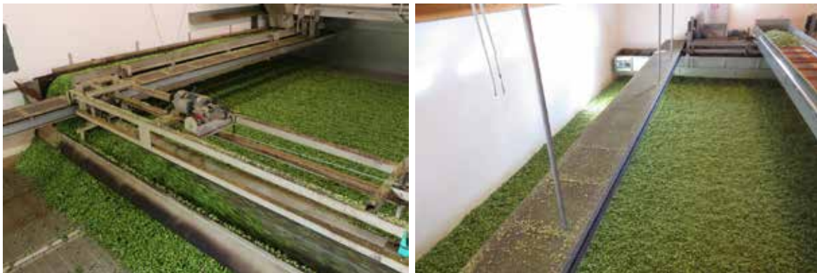
Abb. 48: Befüllung der Aufschütthorde mit Grünhopfen durch automatische Befüll-Vorrichtungen
