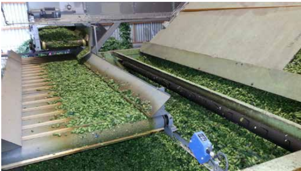
Abb. 63: Schichtweise Beladung des Auftragbandes mit einem Befüllband
