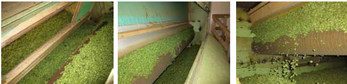
Abb. 65: Praxisbeispiele für Bandabdichtungen (Anfang und Ende oberes Band sowie Übergang zu zweitem Band)
