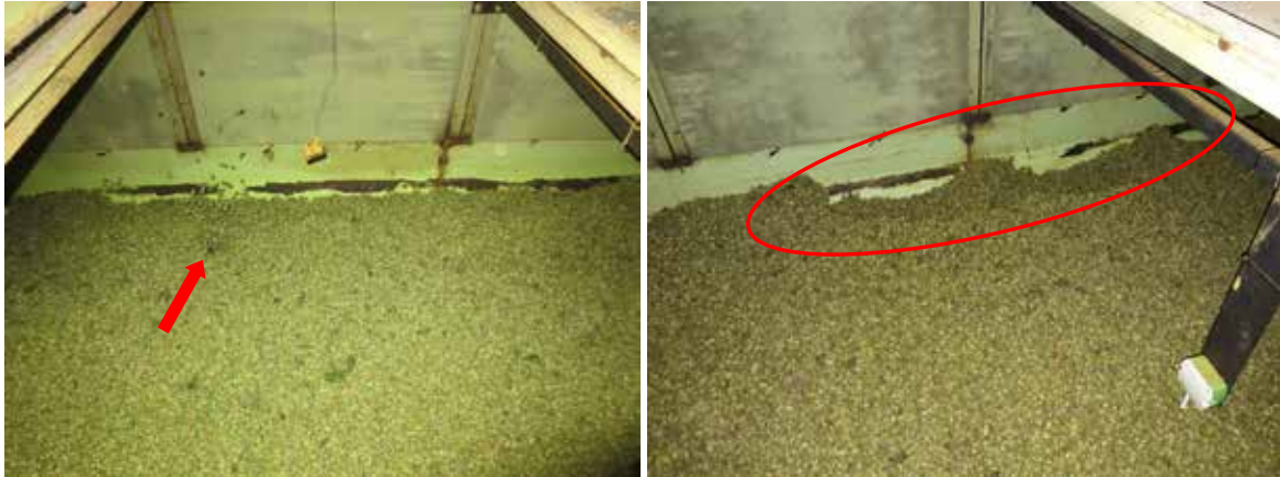
Abb. 64: Aufwirbelungen und Freiblasen von Löchern gegenüber der Einströmseite der Trocknungsluft
