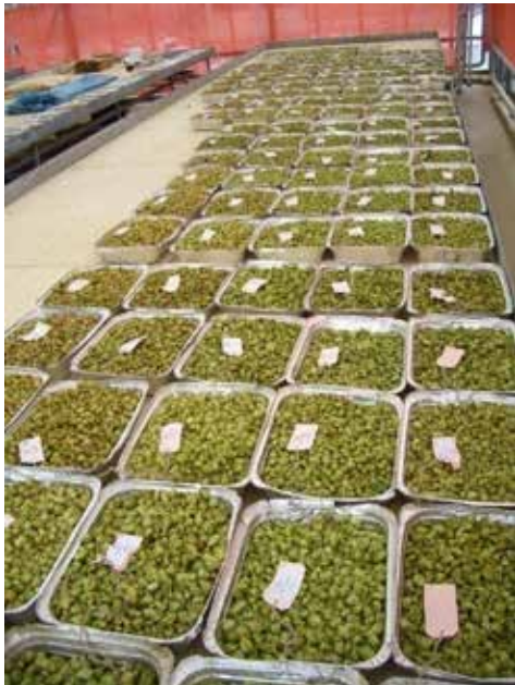
Abb. 23: Hopfenproben unterschiedlicher Sorten zur Untersuchung des Sorptionsverhaltens
