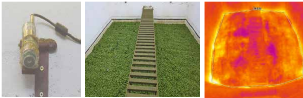
Abb. 53: Wärmebildkamera, Messfläche über der Aufschütthorde, zugehöriges Wärmebild (Bilder Hofer H., 2019)
