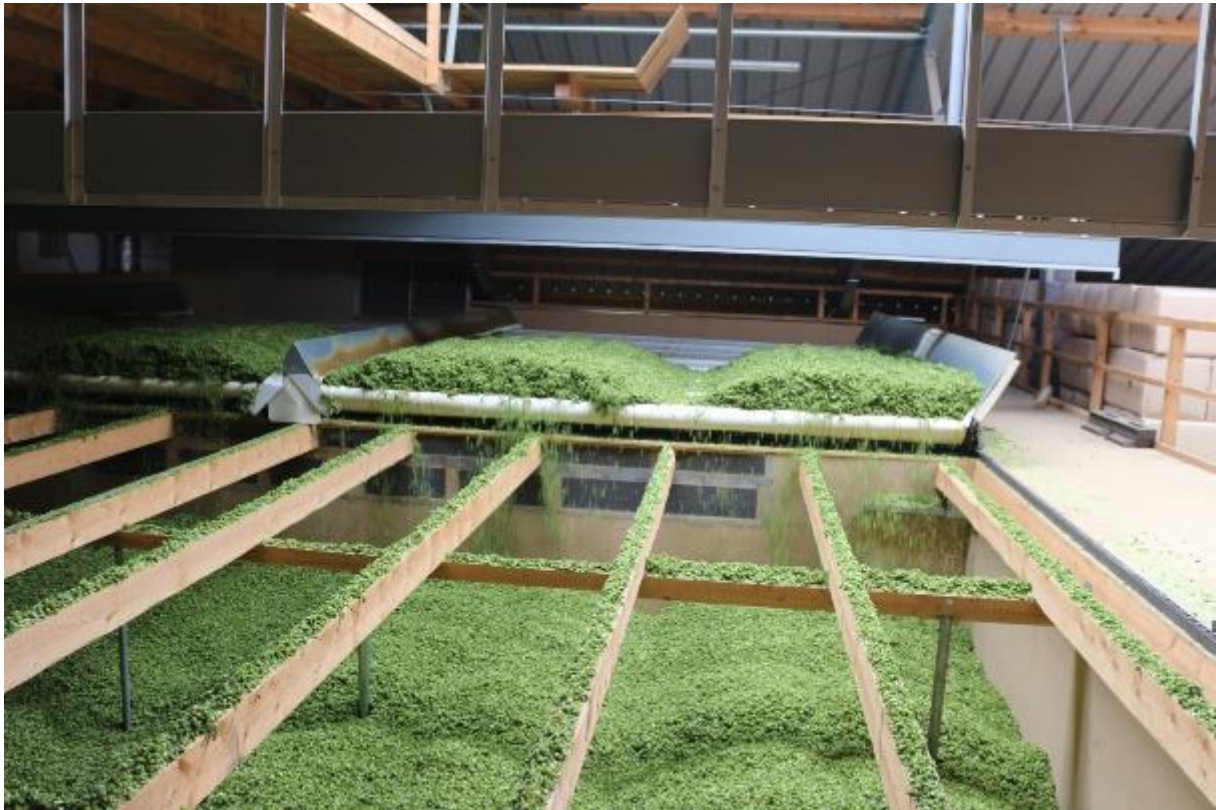
Abb. 80: Befüllen der Konditionierungskammer mit Hopfen frisch aus der Trocknung
