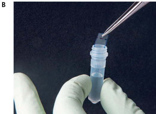
Abbildung 7: Fotografische Darstellung des Versuchs zum re-etablierten Prüfverfahren „Modell A Tauchbad“ im Labor. In (A) ist der realistische Aufbau des Versuchs unter einer Sicherheitswerkbank zur Analyse der Desinfektionsmittelwirksamkeit gegenüber bakteriellen Sporen auf Asservat-Behältermaterial im Tauchbad dargestellt. (B) zeigt das Eintauchen des Keimträgermaterials (Asservat-Behälter) in 1 ml eines Desinfektionsmittels unter Zuhilfenahme einer sterilen Pinzette („Tauchbad“). Eigene Darstellung.
