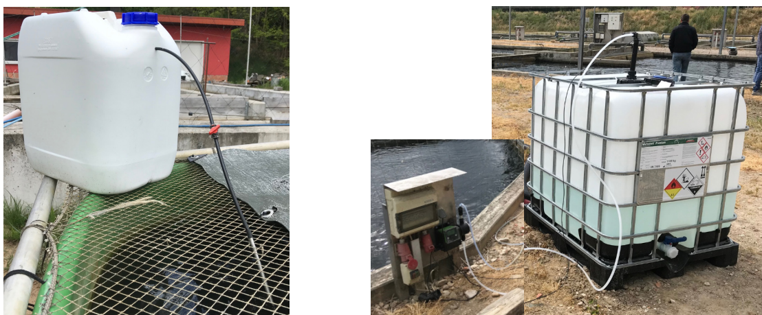
Abb. 2: Zwei Ausbringungsmethoden für PES-Produkte in Aquakulturbetrieben. Links: Saugheber-Prinzip, rechts: elektrische Dosierpumpe.
