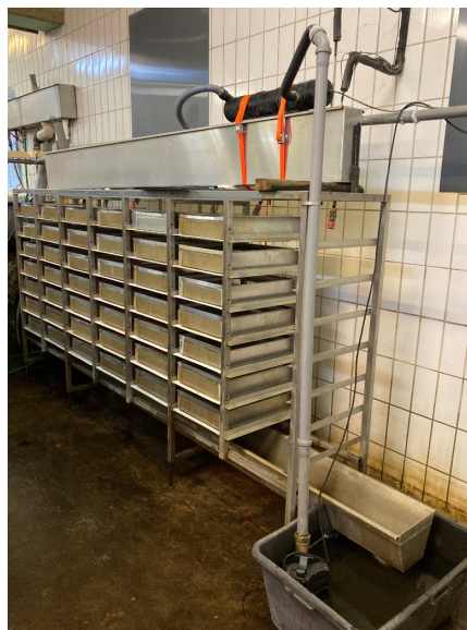
Abb. 18: Foto des untersuchten Brutschrankes und der zylindrischen UV-C-Einheit (oben).
