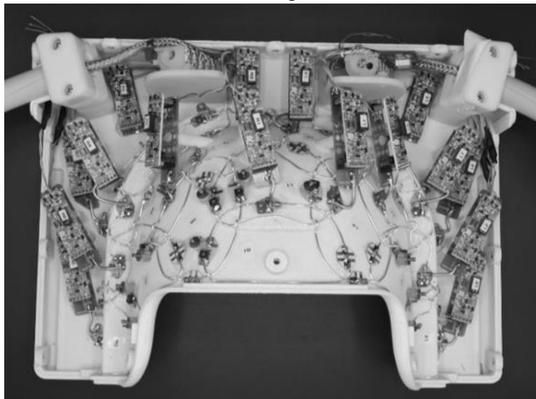
Abb. 1: Aufbau und Verteilung der geometrisch entkoppelten Empfangselemente
