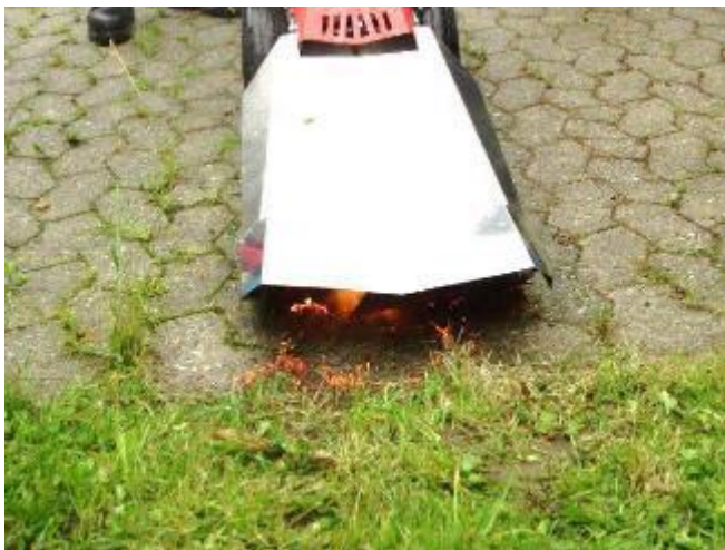
Abb. 11: Infrarot-Geräte und Heißluftgeräte erzeugen eine intensive Wärmestrahlung. So sterben durch die Behandlung nicht nur die Pflanzen ab, sondern auch auf der Bodenoberfläche liegende Unkrautsamen sind meist nicht mehr keimfähig.
