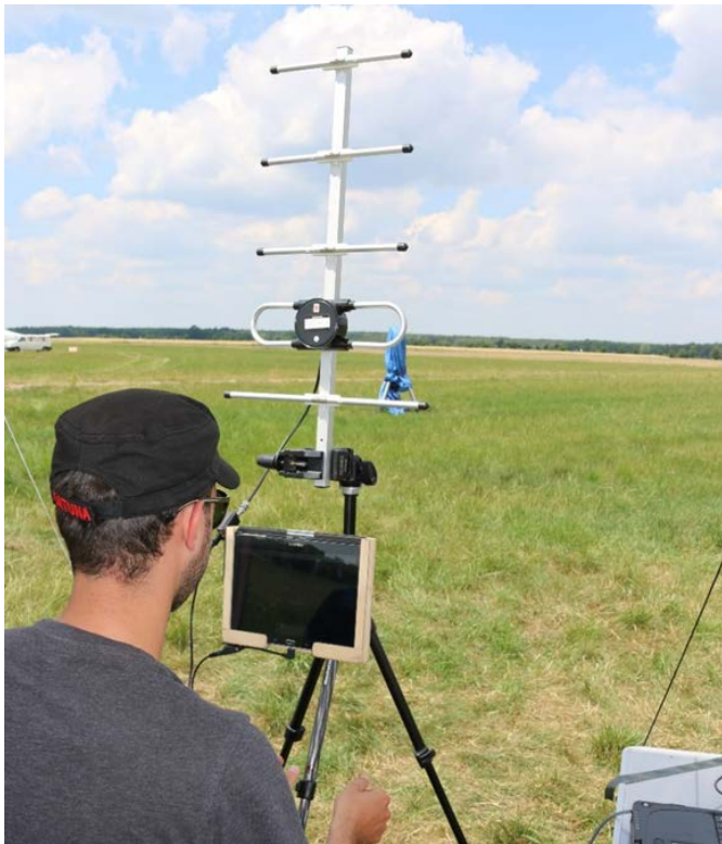
Abbildung 21: Telemetrie-Bodenstation der HSD im vertikalen Betrieb (HSD UMT, 2014)
