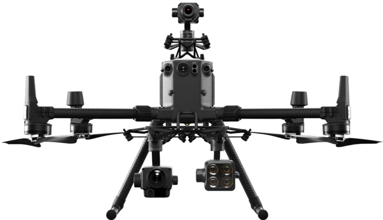
Abbildung 18: DJI M300 RTK mit Payload oberhalb und unterhalb des Multicopters (DJI kein Datum)
