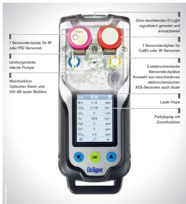
Abbildung 6: Sensorsteckplätze beim X-am 8000 Mehrkomponentenmessgerät (Quelle: https://www.gasmesstechnik.de/documents/products/FotoErwGross/180000999_Detail%202.jpg )
