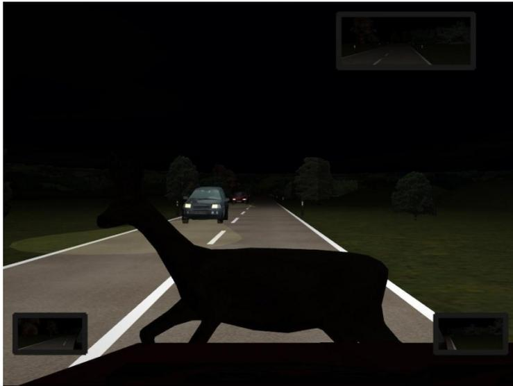
Abbildung 1: Ein Reh ist auf die Fahrbahn gelaufen. Der Proband führte eine Vollbremsung aus, konnte aber den Zusammenstoß nicht vermeiden. Daraufhin wurde das Reh schwarz dargestellt und der Proband durch ein Geräusch auf die Kollision aufmerksam gemacht. Um die Fahrt fortzusetzen, musste der Wagen neu gestartet werden. Ein Ausweichmanöver war durch abgestimmten Gegenverkehr unterbunden.
