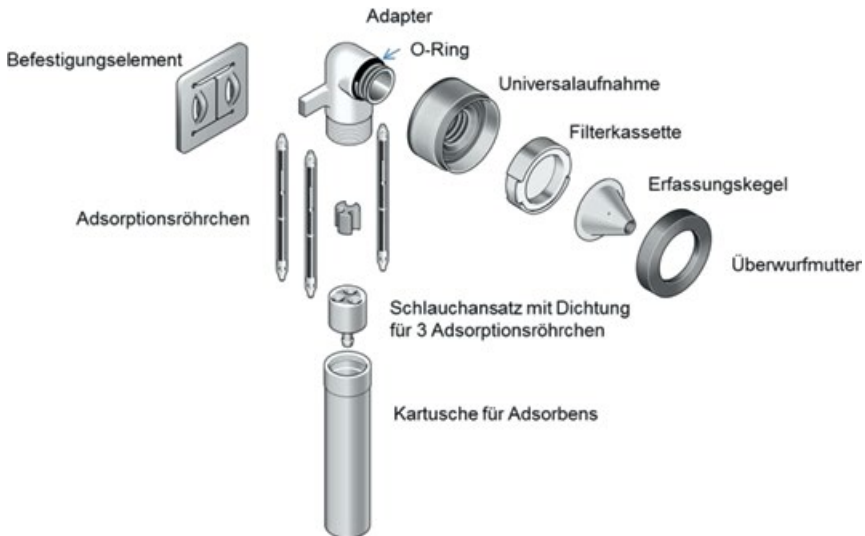
Abb. 11 Schematischer Aufbau des PGP-Systems (Personenbezogenes Gefahrstoff-Probenahmesystem) – GGP-U für E-Staub und Gas-Probenahme [37]
