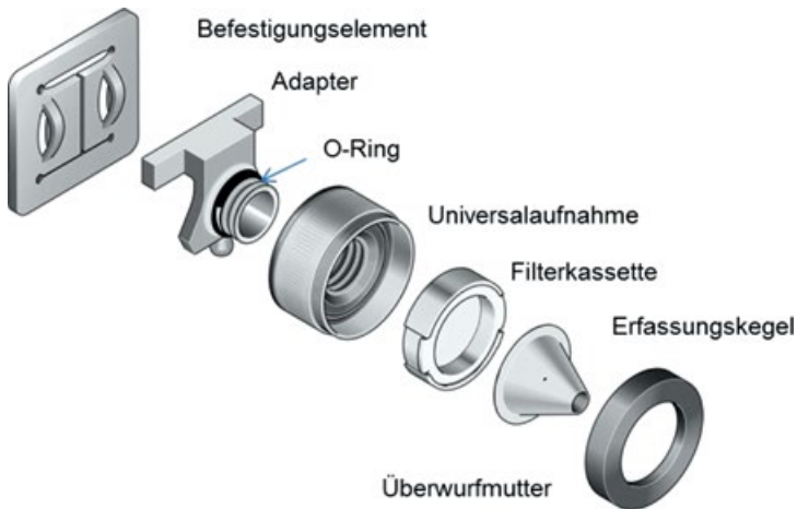
Abb. 9 Schematischer Aufbau des GSP Probenahmekopfes
