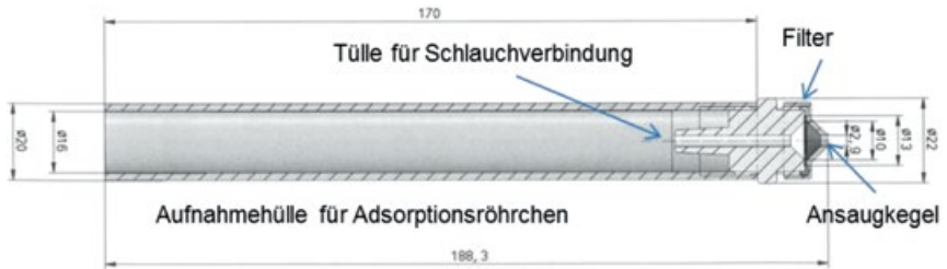
Abb. 12 Schematische Darstellung des Probenahmesystems GGP-Mini [37]
