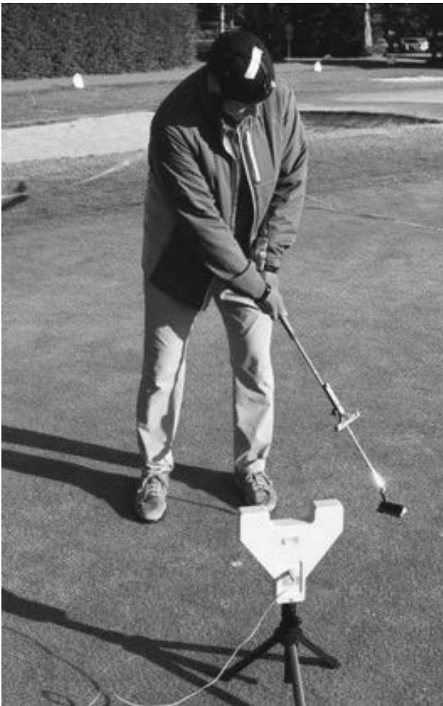
Abbildung 2. Der Autor C.S. Herrmann beim Testen des SAM PuttLab. Man erkennt das an den Putter montierte Triplex und den Ultraschallempfänger auf dem Grün. Ebenfalls zu erkennen ist die Durchführung des Experimentes auf dem Grün eines Golfplatzes zur Erhöhung der ökologischen Validität im Vergleich zu einem Laborexperiment auf einem künstlichen Rasenteppich.
